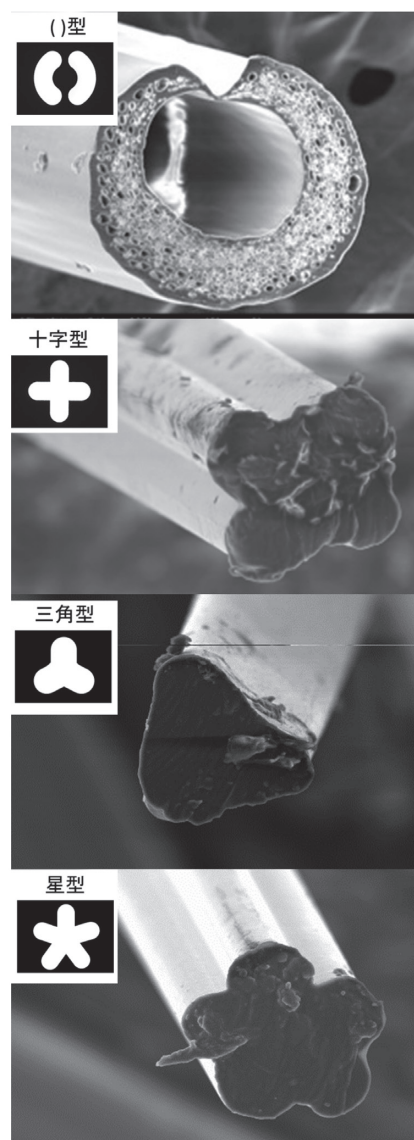
図8 異形ダイを使用して作製したPHBH繊維。左上がダイの形状
