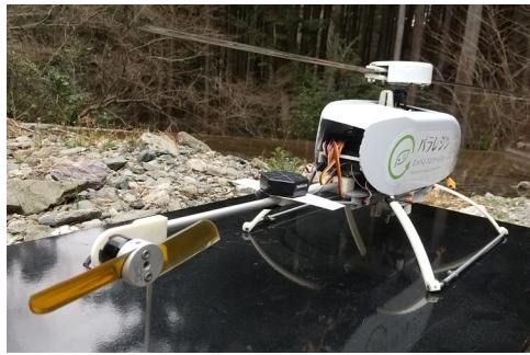
ラジコンヘリコプターの尾翼に成形し飛行テストを実施
