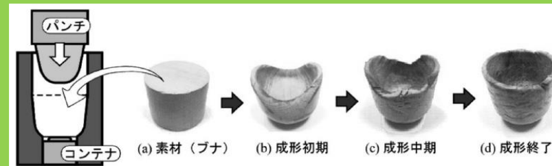
木質流動現象を用いた木材塑性加工（金山，2016）
