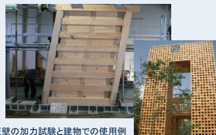
板壁の加力試験と建物での使用例
